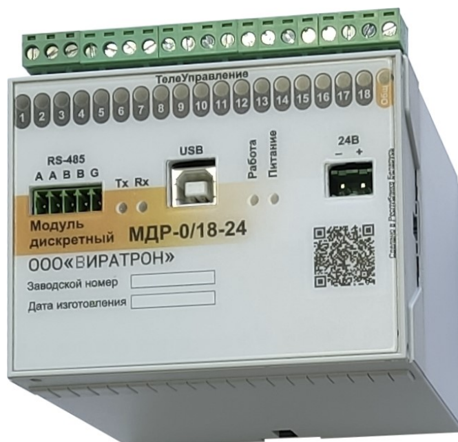
Рисунок 9 – Внешний вид модуля МДР-0/18-24
