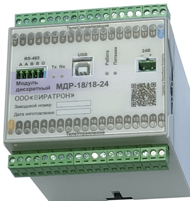
Рисунок 13 – Внешний вид модуля МДР-18/18-24
