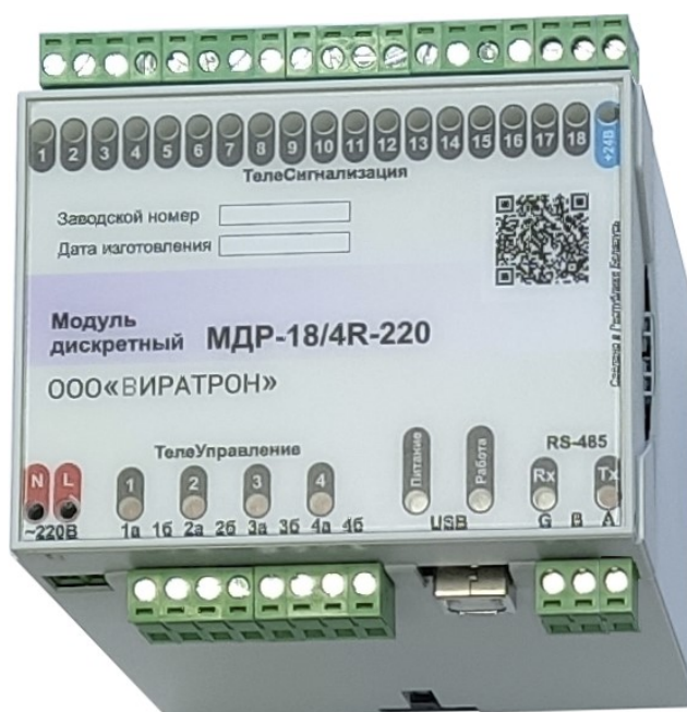
Рисунок 3 – Внешний вид модуля МДР-18/4R-220
